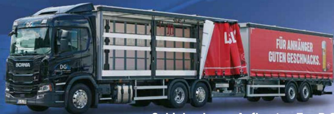
Schiebepan-Aufbauten Typ P-CS
